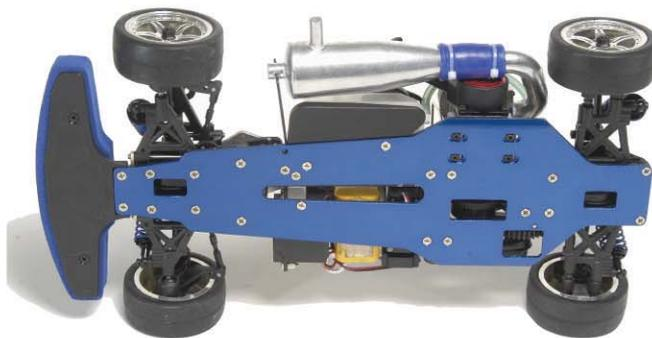
**New-look oblige, le châssis intégralement fraisé adopte une belle anodisation bleu et l'on remarque aussi la nouvelle et judicieuse protection de réservoir en plastique.**
