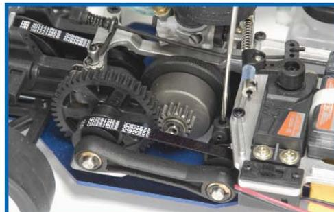
**Pour ne pas souffrir du surplus de puissance, la transmission de la TS-4n Version 2.0 adopte de nouvelles courroies renforcées. On remarque les véritables triangles supérieurs arrière, plus rigides.**
