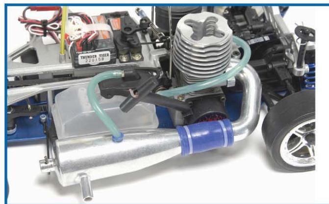
**La V.2 dispose d'une nouvelle motorisation Thunder Tiger, un Pro 12 BX-S de 2,1cc, toujours équipée d'un carburateur à vis de reprise et d'un démarreur à tirette. Avec son nouvel échappement gros volume, les performances sont en nettes augmentations, tant en reprise qu'en vitesse de pointe.**
